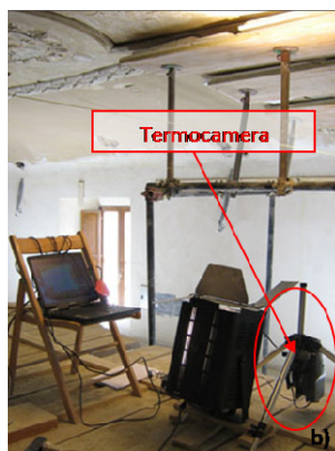
Fig. 2.10 – Termocamera utilizzata per i rilevamenti.
