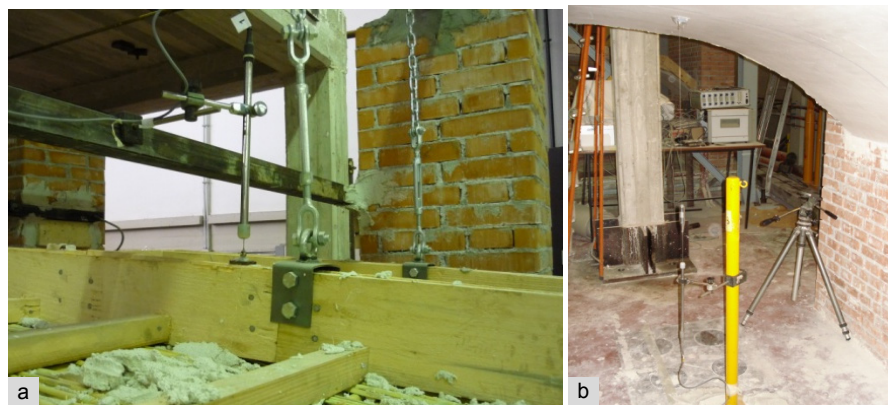
Fig. B.6 a – Trasduttore verticale all'estradosso.
