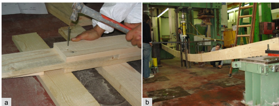
Fig. B.16 a) – Immagine durante la costruzione di una delle travi.
