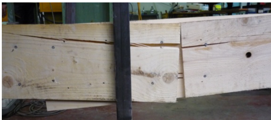
Fig. B.17 c) – Apertura del giunto in prossimità della mezzeria alla fine della prova. Si nota come il contatto tra i lembi superiori ha provocato la rottura del materiale mentre inferiormente l'allontanarsi tra i lembi ha provocato lo sfaldamento del chiodo.
