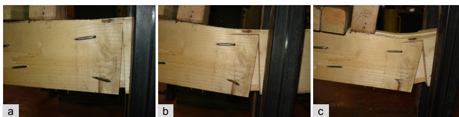
Fig. B.17 a) – Apertura del giunto in prossimità della mezzeria nelle fasi iniziali della prova.
