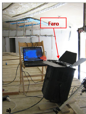
Fig. 2.9 – Faro impiegato come sollecitazione termica per l'indagine sulla volta e sistema di acquisizione.
