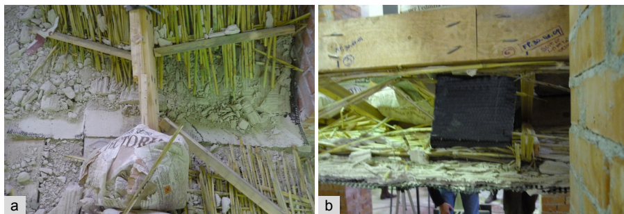
Fig. 3.40 a) – Scorrimento rete e rottura dello stuoio nella volta n°2.
